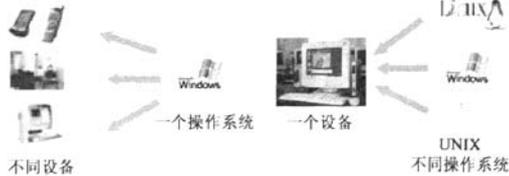
图 2 传统计算模式中用一个操作系统去适应不同的硬件设备
